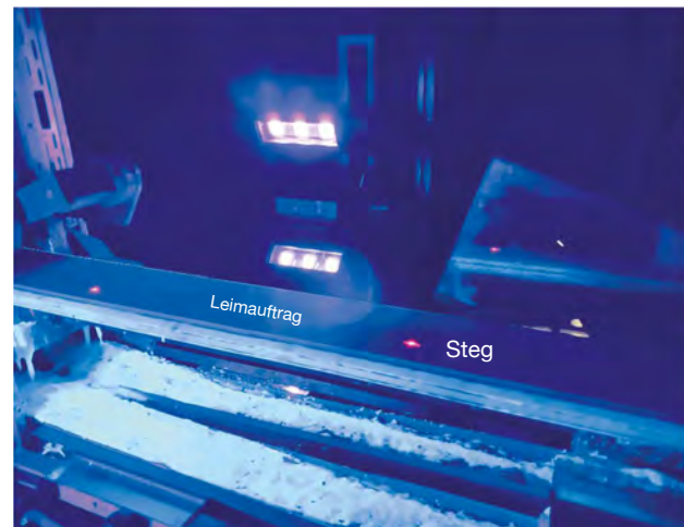
Der durchgängige Leimauftrag auf dem Steg wird automatisiert unter UV-Licht überwacht.
