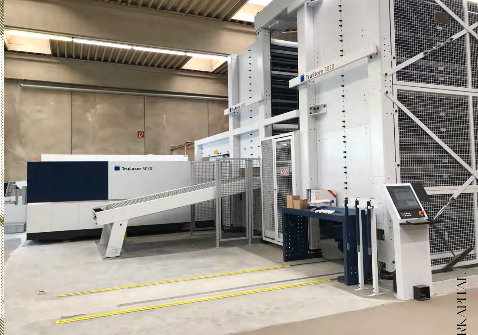
Die neue Trumpf Fiberlaseranlage bei umdasch The Store Makers in Leibnitz reduziert den bisherigen Energieeinsatz für Schneidarbeiten auf die Hälfte.
